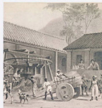
Figura 2.8. Los trapiches fueron las primeras máquinas empleadas en el proceso de extracción de azúcar.
